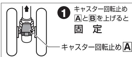
キャスター回転止めAとBの調節で、前輪を①で固定、②で左右40度に回転、③で360度に回転、の状態に設定できます。
