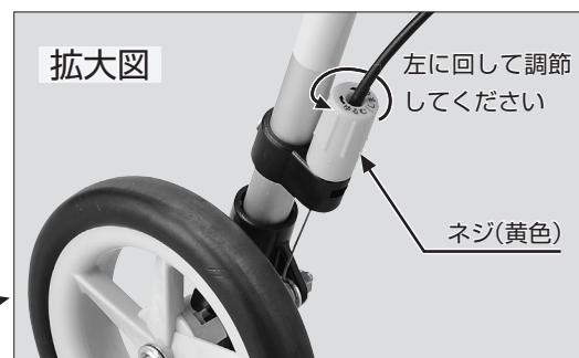
手元ブレーキが効きにくくなったり、駐車用ストッパーが車輪に当たって音がする場合は、後輪上部左右にあるネジ(黄色)を左に回して調節してください。
