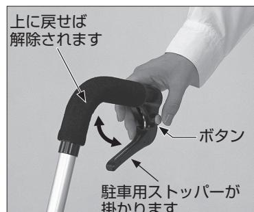
手元ブレーキレバー内側のボタンを押すと駐車用ストッパーが掛かります。手元ブレーキレバーを引き上げてはなすとストッパーが解除され、歩行開始の状態に戻ります。
