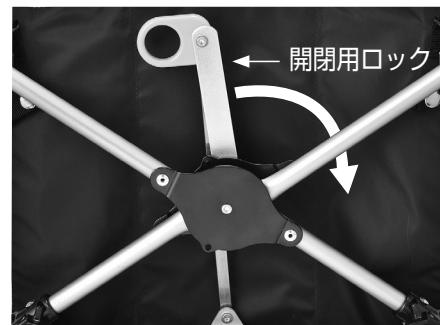
開閉用ロックを右に充分に押し下げ、左右の持ち手を少し持ち上げてたたみます。
